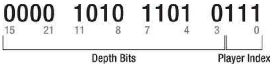
**Gambar 2.28** Struktur 16-bit pada setiap *depth pixel*
